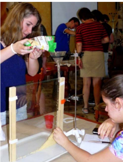
4. ábra. Tanulói mérések: granulált anyagok rézsűszögének mérése (balra) hidrosztatikai feketedoboz (jobbba).
