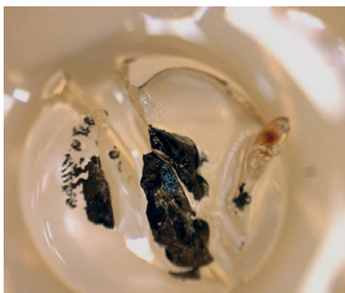
6. ábra. Ezüstkiválás akrilgyöngyben (ezüst-nitrát-oldat elektrolízise)
